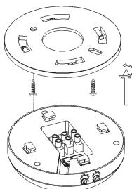
5.3 Заздалегідь відключивши напругу, підключіть табло до живлячої мережі згідно з схемою:
