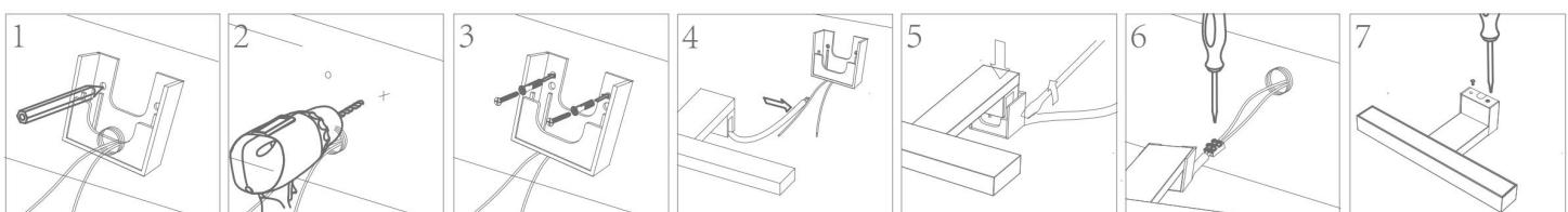
4.3 3 варіанти монтажу - за допомогою гвинтів, затискачів або настінного монтажу (з невеликою настінною коробкою всередині):
